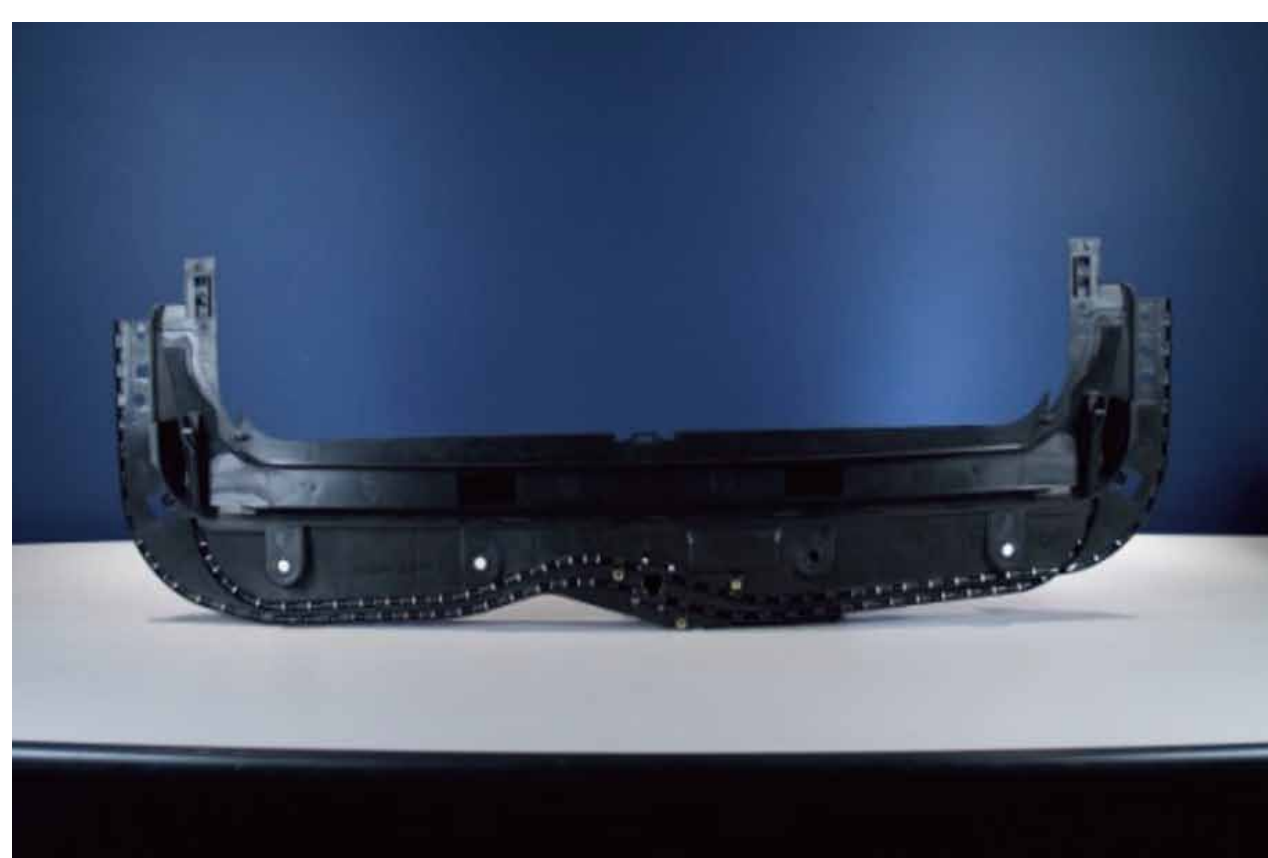
サンルーフフロントフレーム Sunroof Front Flame
