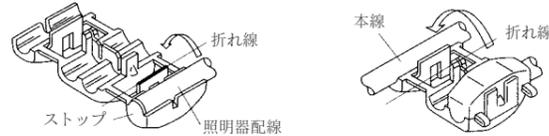
①照明器の配線を図のストップに突きあて、矢印の方にたたみ返し、プライヤでラッチがかわむまで締め付けます。
