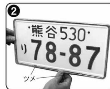
②続いて「飾り枠」の裏面の**下側**にあるツメ2か所を、照明器の**外周縁**とナンバープレートの下側を挟み込むように引っ掛けてください。
