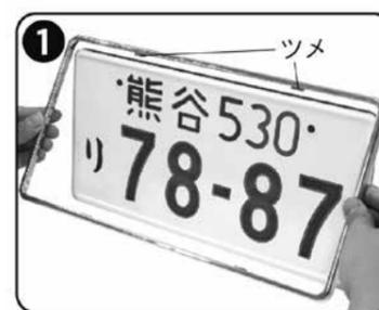
①まず、「飾り枠」の裏面の**上側**にあるツメ2か所を、照明器の**外周縁**とナンバープレートの上側を挟み込むように引っ掛けてください。
