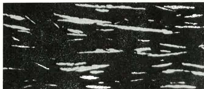
図 2 ノンリーフィングタイプアルミ顔料の塗膜断面
