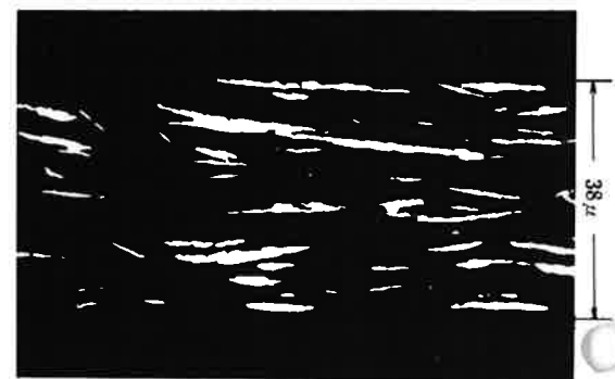
図4. ノンリーフィングタイプ・アルミニウム粉顔料の塗膜断面写真
