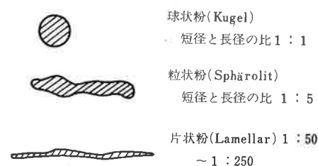
図1. 金属粉の種類と形状
