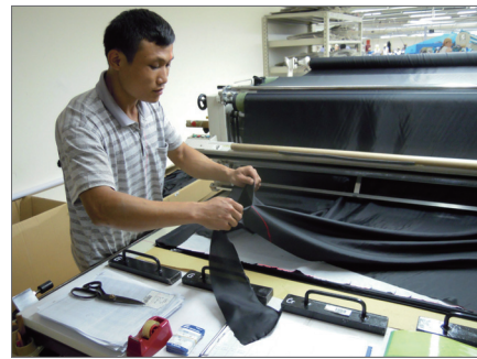
延反途中の丁寧な手裂き
