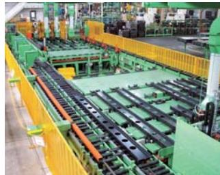
鉄骨部材の製造工程
