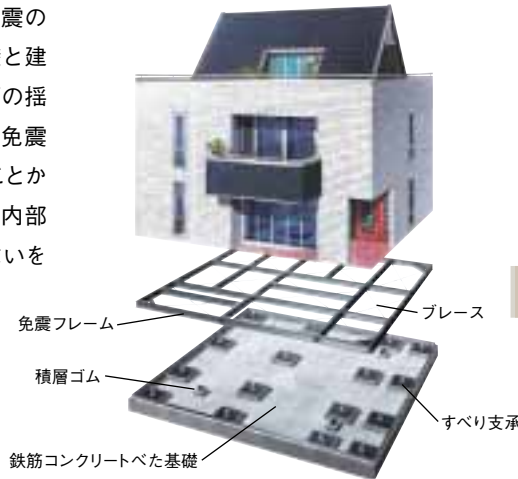
【免震構造概念図(すべり系の場合)】
