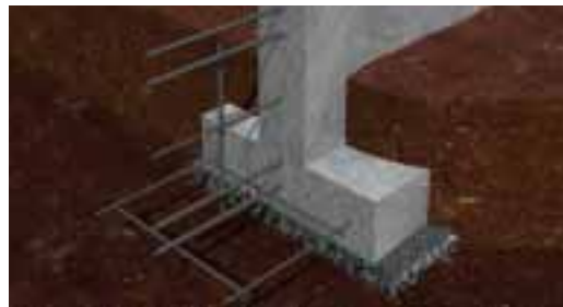
豊富な配筋で住まいを支える基礎
