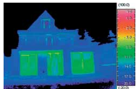
サーモグラフィーによるヘーベルハウス白老実験棟の熱画像
