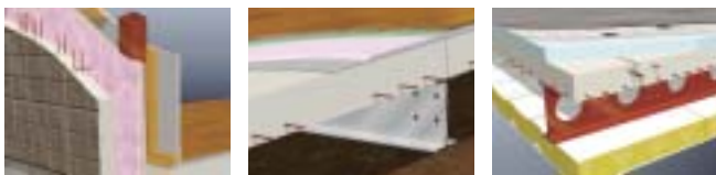
ダブルシェルター・ウォール(外壁) ダブルシェルター・フロア(1階床) ダブルシェルター・ルーフ(屋上)
