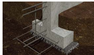
基礎大梁配筋
