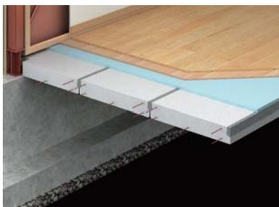
【ハーベル100mm厚】+高性能断熱材【ポリスチレンフォーム20mm厚】を組み合わせた床。
