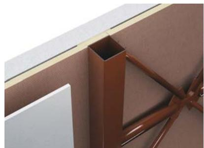
【ハーベル75mm厚】+高性能断熱材【ネオマフォーム20～25mm厚】による二重の断熱ゾーンを、鉄骨柱の外側に配置。
