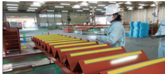
鉄骨階段のすべり止め対策
