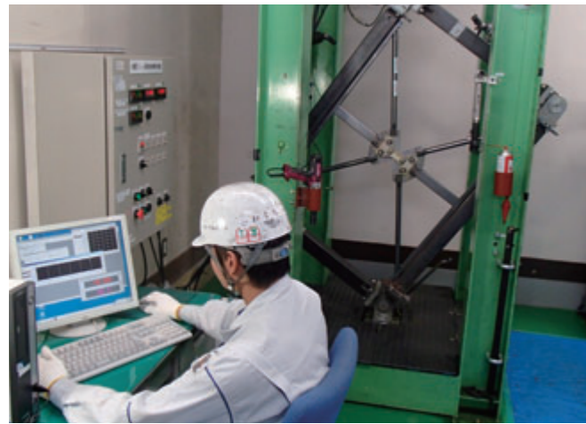
信頼性試験の一例「制震フレームの構造試験」
