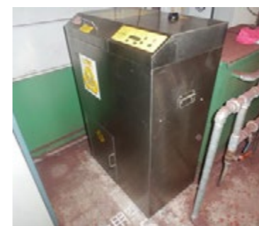
廃シンナー蒸留再生装置
