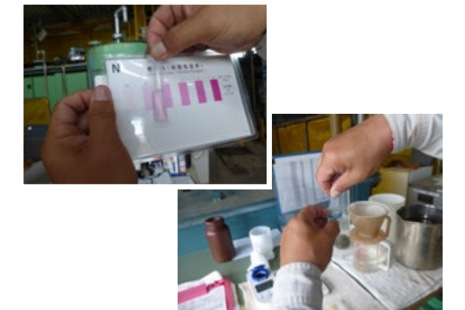
排水処理場 パックテスト
