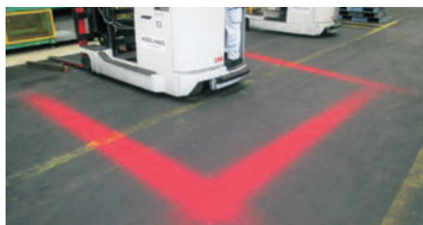
フォークリフトの運転手の死角となる場所に照射されるLEDライト
