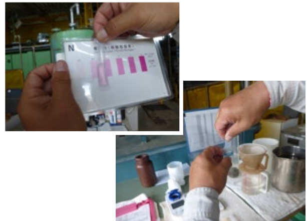
排水処理場 パックテスト
