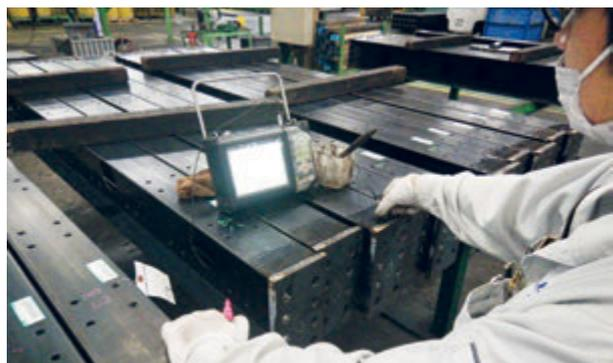
溶接内部の欠陥を超音波で診るUT検査
