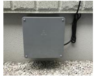
設置した地震計
