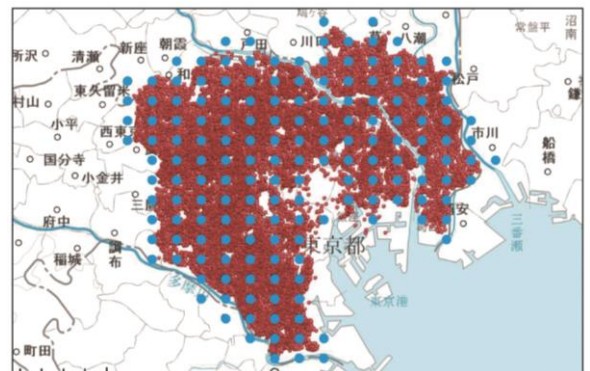
●・・・地震計を設置したヘーベルハウス(約2キロ間隔) ●・・・地震計を設置していないヘーベルハウス・メゾン (東京 23 区内:約 4 万棟)
