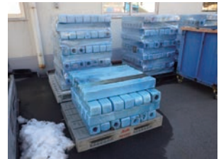
インゴット化された廃プラスチック
