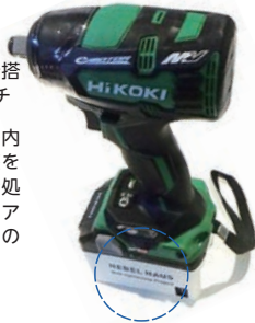
打音検査した際の正しい締結音 (超音波) を現場の締結音との比較照合で判定
