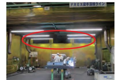
改修前の集塵機（溶接ヒュームの吸い込み口が上方にあり溶接ヒュームの吸い込みが弱い）
