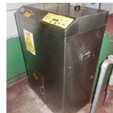
廃シンナー蒸留再生装置
