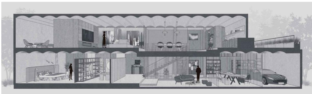
アーチ状の曲面天井「ポールト」を1・2階ともに採用
